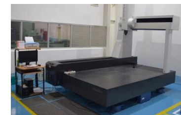
Máy đo 3D Crysta-Apex S 122010 (Hãng Mitutoyo)
