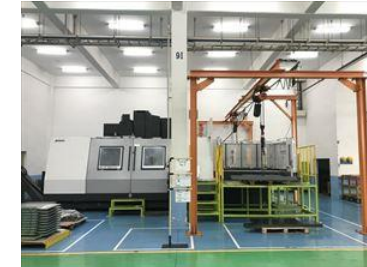
Máy gia công trung tâm trục đứng Millac 1502VII-e (Hãng OKUMA)
